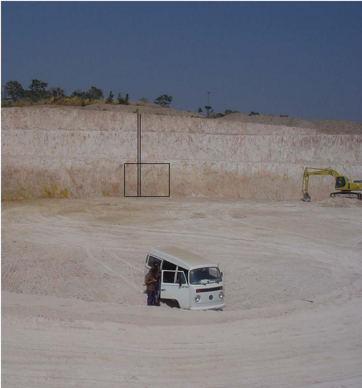
Figura II.5 – Vista geral da área estudada. Há 3 níveis de lavra com taludes de 5 m de altura. No canto esquerdo do piso inferior ocorrem metalamitos alterados de cor amarela e a direita predomina tom creme com vermelho e em direção ao topo cor creme claro, dominante na área. A quadricula marcada representa a foto II.6 e as linhas verticais o perfil amostrado no talude; o furo de sonda foi feito na mesma sequência 6 metros abaixo.
