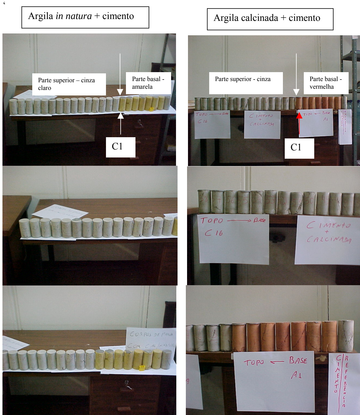
Figura VI.16 – Comparação da variação de cor em corpos-de-prova de cimento com argila in natura e com argila calcinada. Em ambas o lado esquerdo de cada foto representa o topo, o lado direito a base e o corpo-de-prova cinza na extrema direita refere-se à referência de cimento. Nos dois experimentos a amostra C1 divide o perfil amostrado em parte basal e parte superior.
