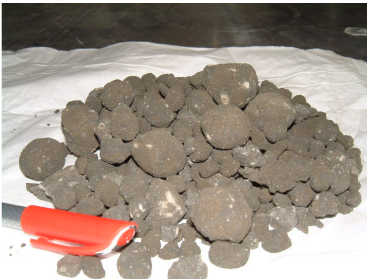
Figura III.2 – Fotografia do clínquer portland, obtido através da queima da farinha crua em forno rotativo a temperaturas por volta de 1450 °C
