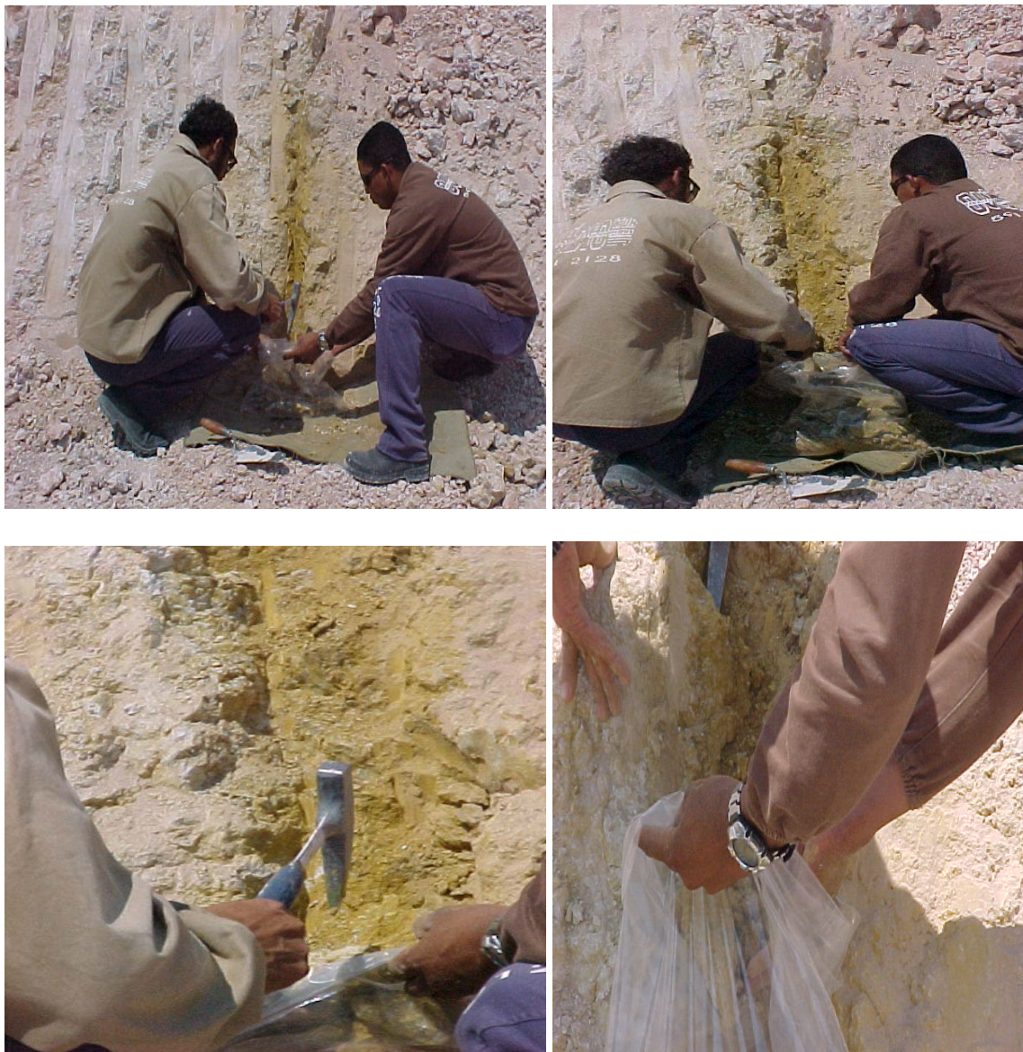
Figura V.1 – Amostragem de canal. A foto exhibe amostragem na base na mina Bonsucesso
