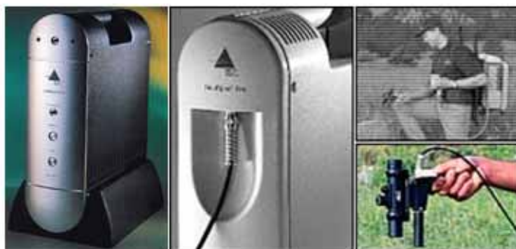
Figura 3.12. Ilustração do espectrorradiômetro utilizado na pesquisa, modelo FieldSpec Pro FR (350 - 2500 nm), produzido pela Analytical Spectral Devices (ASD Inc.).
